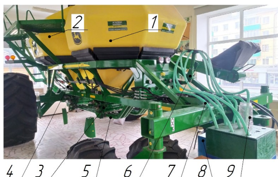
Рис.1. Лабораторная установка для определения аэродинамических показателей пневматической системы
